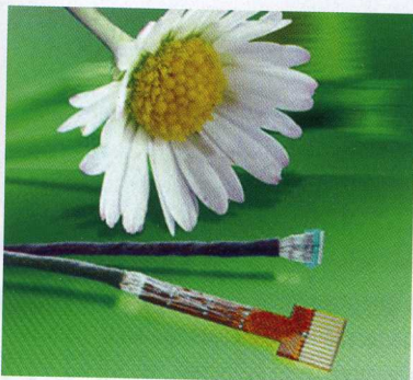
Рис.3. Кабельная сборка для эндоскопического оборудования
